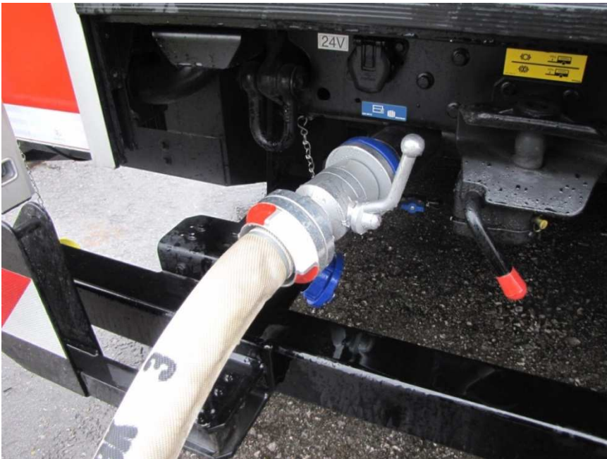
Abb. 7. Am Tankeinfüllstutzen angebrachter Kugelhahn
