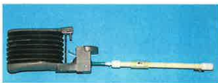
Abb. 1: Tenax® - Probenahmeröhrchen mit manueller Gasspürpumpe
