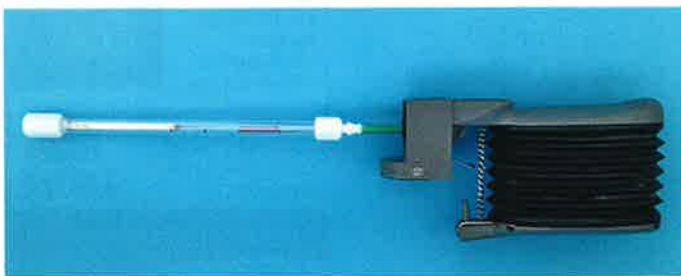
Abb. 1. Tenax ® - Probenahmeröhrchen mit manueller Gasspürpumpe
