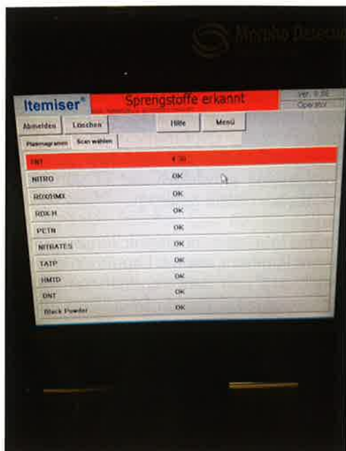
Abb. 3: Auf dem Display des Ionenmobilitätsspektrometers erscheint die Anzeige „Sprengstoffe erkannt“ und der detektierte Sprengstoff TNT
